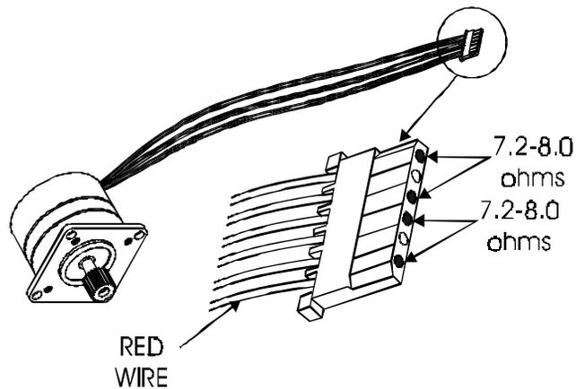
**Figure 3-8. Stepper Motor.**
